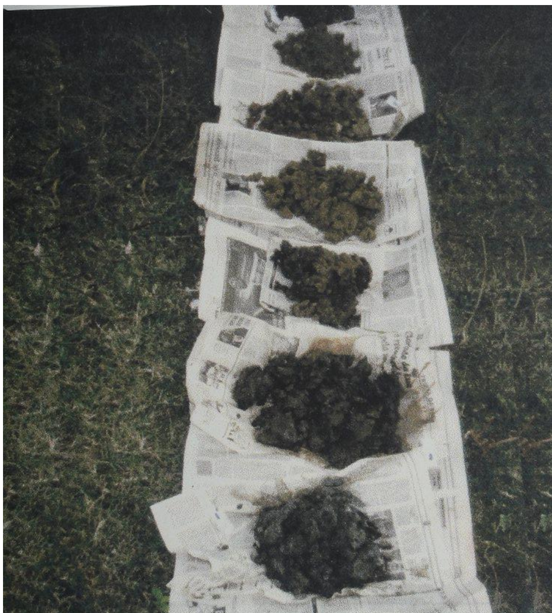
Foto 6-20. A amostragem do perfil do solo exibe a variação de coloração do vertissolo, apresentado na sua feição superior (topo) a cor amarela alaranjada (material proveniente do aterro), para cinza escuro da base (folhelho).
