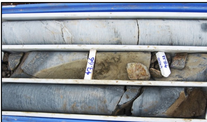
Fig 7 - Testemunhos de sondagem rotativa mostrando fraturas abertas com sinais de dissolução na zona superior do maciço calcário são. Foto ARSantos.
