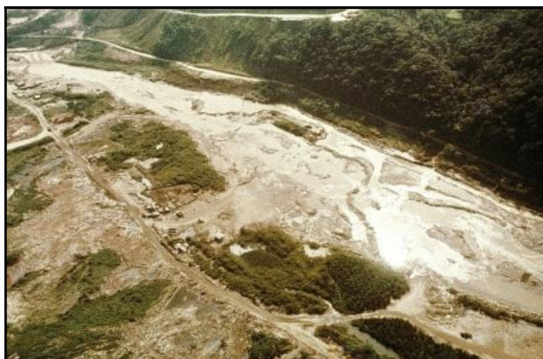
Foto mostrando o intenso assoreamento a que foi submetido o Rio Cubatão como consequência da erosão sobre os solos expostos durante a implantação da primeira pista da Imigrantes. (Foto IPT)
