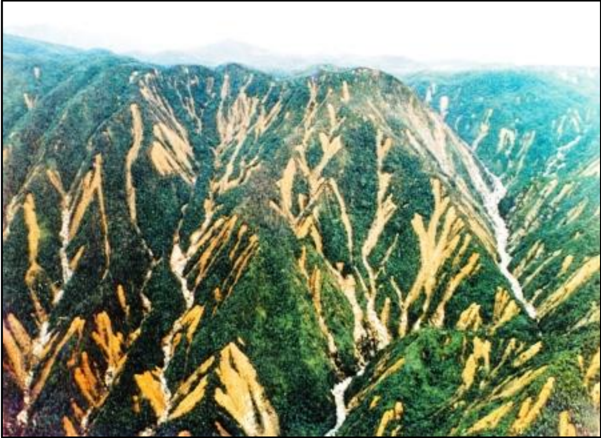
Foto mostrando inúmeros deslizamentos ocorridos nas encostas do Vale do Rio Mogi no ano de 1985. Esse evento foi associado aos problemas ocorridos com a vegetação por consequência da poluição do Pólo Industrial de Cubatão. (Foto Arquivo IPT)
